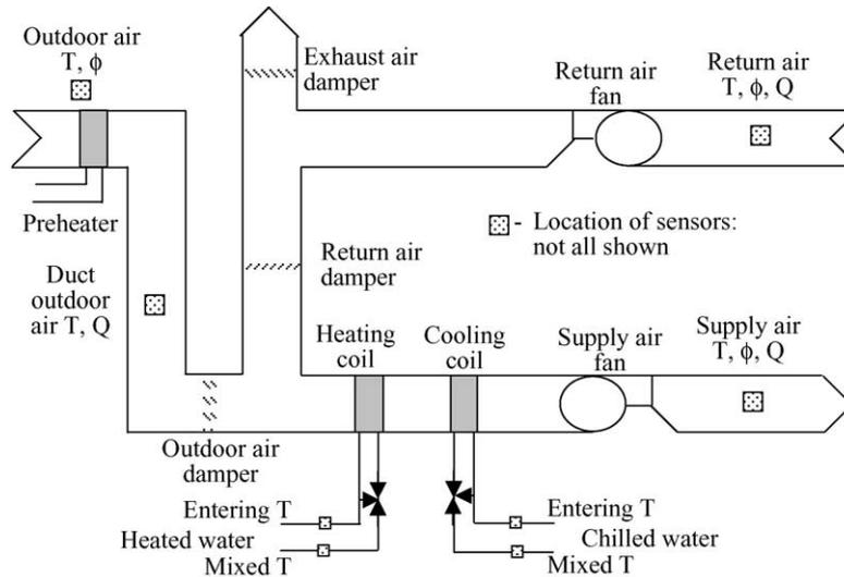
Fig. 2. Air-handling unit [11].
